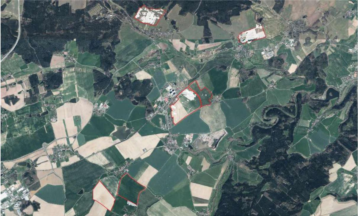
Abbildung 22: Untersuchte Flächen der Agrargenossenschaft Niederpöllnitz e.G mit detektierten Dränagen [Eigene Abbildung]
