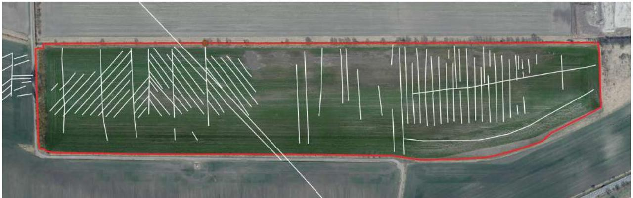
Abbildung 14: UAV-DOP mit 2,64cm/pix GSD vom 09.04.2018 inklusive detektierter Dränagen [Eigene Abbildung]
