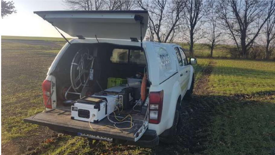
Abbildung 74: Aufbau der Aparatur des Neutronendetektors für den Feldversuch am 05.12.2019 [Eigene Abbildung]
