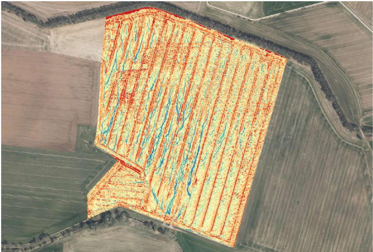
Abbildung 33: Fahrspuren im **TWI** auf Grundlage des UAV-**DOM** mit 1m **GSD** vom 28.06.2017 [Eigene Abbildung]
