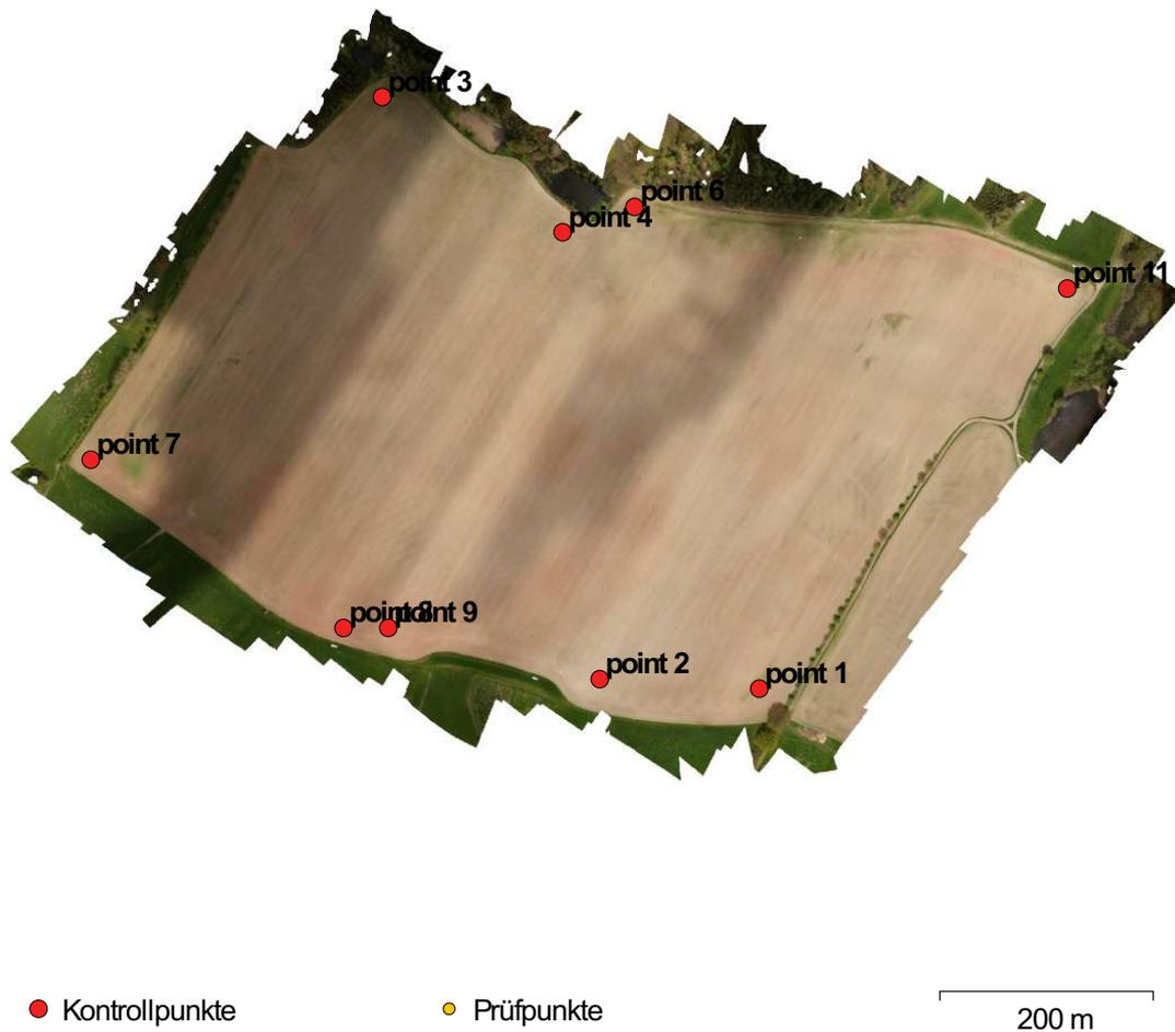
Fig. 3. Bodenkontrollpunktpositionen.
