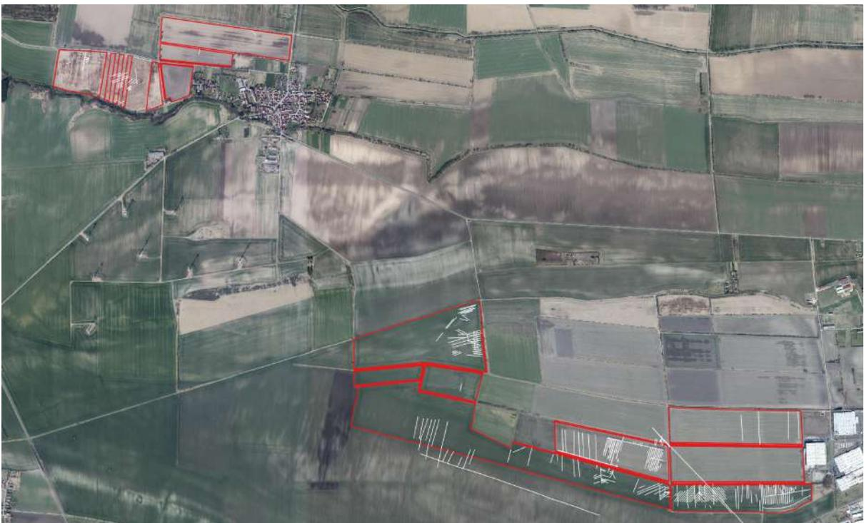
Abbildung 21: Untersuchte Flächen der Agrargenossenschaft Weißensee e.G. mit detektierten Dränagen [Eigene Abbildung]
