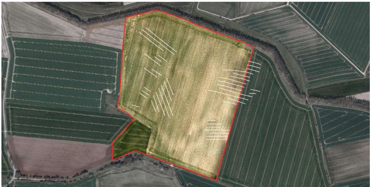
Abbildung 13: UAV-DOP mit 1,89cm/pix GSD vom 11.05.2017 inklusive detektierter Dränagen[Eigene Abbildung]
