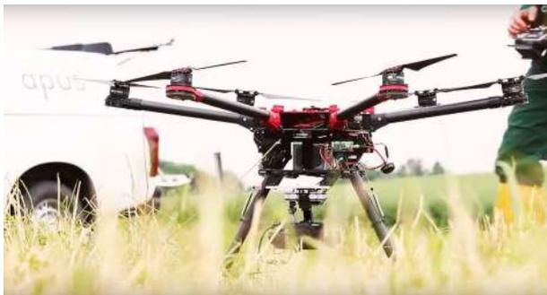
Abbildung 10: Frame: S900/DJI mit Pixhawk PX4
